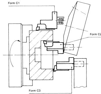
Einsatz von Axial-Werkzeughaltern bei rechter Spindeldrehrichtung
