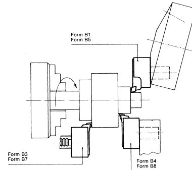
Einsatz von Radial-Werkzeughaltern bei rechter Spindeldrehrichtung
