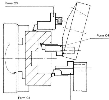
Einsatz von Radial-Werkzeughaltern bei linker Spindeldrehrichtung
